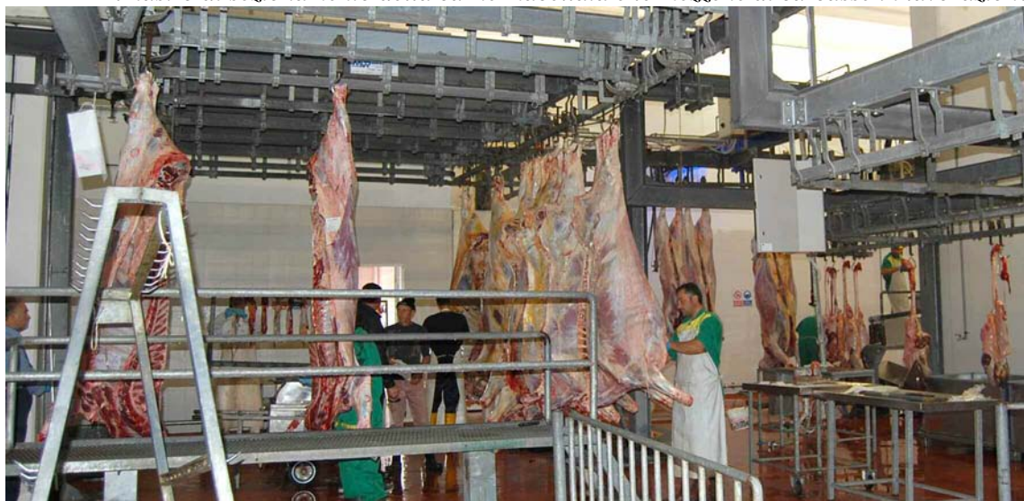
Il nastro di sezionamento della carne macellata e le mezzene di carcasse in lavorazione
